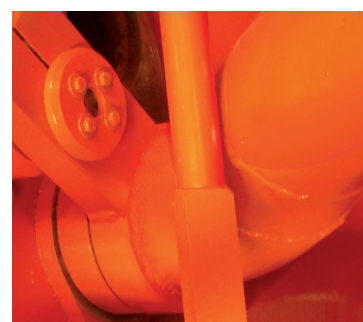
Trémie dotée d'un robinet « S », à disque et plaque d'usure
