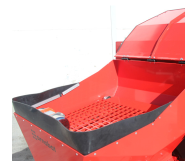
Grille pour béton à vibreur électrique Couvercle de protection
